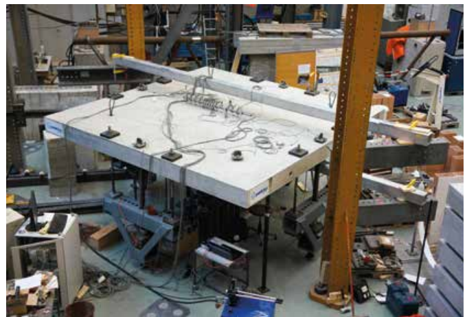
Peikon PSB-lävistysraudoituksien ETA-testijärjestelyt pienille (vas.) ja suurille laatoille Lausannen teknillisessä korkeakoulussa (EPFL).
