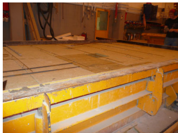
Kuva 23. Diagonaaliansaiden ankkurointi sisäkuoreen.
